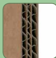
sedemvrstvá vlnitá lepenka s vlnou ABC, cca 12 mm
