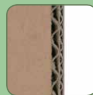
päťvrstvá vlnitá lepenka s vlnou BE, cca 5 mm
