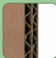
päťvrstvá vlnitá lepenka s vlnou BC, cca 7 mm
